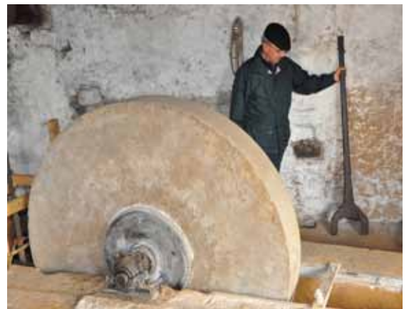
Monumente im Gehlerhaus: Schleifstein mit 2 Meter Durchmesser und Konrad Eichenberger mit dem speziellen Schraubenschlüssel dazu.
